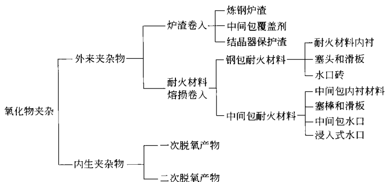
图 1-1 连铸过程中氧化物夹杂的来源
