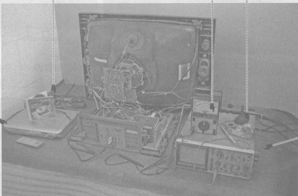
上图所示为彩色电视机检修过程中的基本环境和设备要求，读者在实际的操作过程中，可以根据自身实际需求来搭建简易操作平台。
