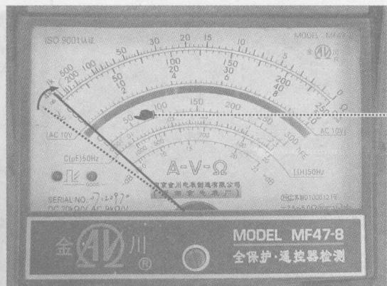
在测量元器件或电路的电阻值时，每调整一次挡位，就需对万用表进行调零校正，即将两表笔短接，然后调整零欧姆校正钮，使指针指向 $0\Omega$ 。
