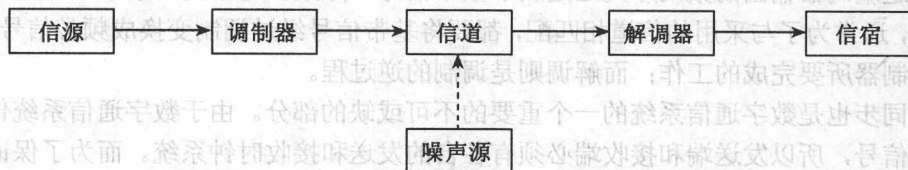
图 2-2 模拟通信系统模型
