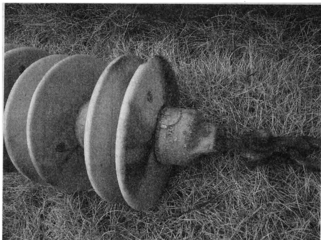
图1-2 有放电痕迹的绝缘子
