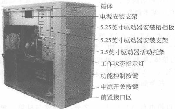
图 1-3 ATX 立式机箱及其控制面板基本结构
