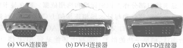
图 1-16 显示器上配置的显卡接口连接器
