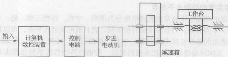
图 1—3 开环控制框图
