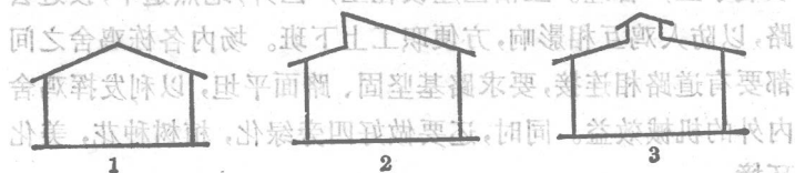
图1 开放式鸡舍屋顶的形式
