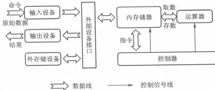
图1.1 计算机硬件系统基本组成框图
