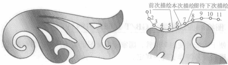
图 1-10 用曲线板连接非圆曲线的方法
