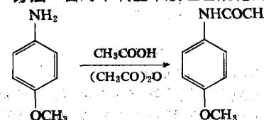
方法1：对甲氧基苯胺和乙酸，将反应物中过量乙酸和反应生成的水一起蒸出，反应产物用减压蒸馏的方法提纯。每吨产品消耗对甲氧基苯胺(99%)773公斤，冰醋酸(98%)450公斤。
