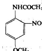
这个产品的生产方法是：先将氯苯、对乙酰氨基苯甲醚及亚硫酸氢钠加入硝化釜，调节温度至28℃，于4小时内加入61%硝酸，反应温度为25—30℃。加毕，保温1.5小时。然后加水静置，分出上层酸水，将物料干燥，得熔点116℃的成品。(上海染化九厂生产)
