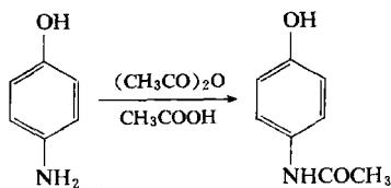
**方法1：**将对氨基酚加入稀乙酸中，再加入冰醋酸，升温至150℃反应7小时，加入乙酐，再反应2小时，检查终点，合格后冷却至25℃以下，甩滤，水洗至无乙酸味，甩干，得粗品。
