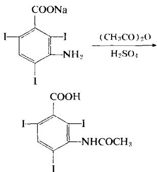
先后将乙酐、硫酸加入反应罐，冷却至40℃后加入3-氨基-2, 4, 6-三碘苯甲酸钠。升温，于80℃反应3小时。冷却至室温，甩滤，用蒸馏水洗，得醋碘苯酸粗品。将粗品加水和EDTA搅拌1小时，过滤，用水冲洗4次。再将醋碘苯酸加入罐内，用氨水调节pH至8.5。过滤，用95%乙醇反复泡洗，滤去乙醇，得醋碘苯酸铵。将其溶解于蒸馏水，加活性炭脱色过滤，滤液用3N盐酸调节pH至1，再过滤，用50℃热蒸馏水洗至无氯离子，烘干，得醋碘苯酸。
