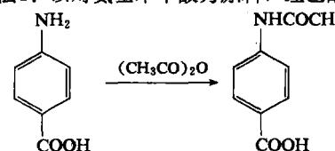
将对氨基苯甲酸溶于乙酸乙酯，搅拌下加入乙酐，温度升至70℃。然后冷却过滤，水洗二遍，再用乙醇结晶而得成品。
