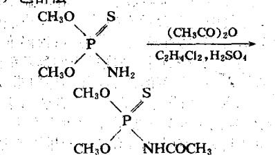
将带溶剂的胺化物由高位计量槽放入酰化釜中，开启搅拌，再由乙酐高位计量槽加入乙酐于酰化釜中，再开启冷冻盐水，使釜中温度降至10℃时，将浓硫酸从高位计量槽慢慢地滴加进反应釜中，滴加硫酸完后，开启空压，将夹套中的冷冻盐水排出，用蒸汽慢慢加压，使釜中温度升至55—60℃，保持50分钟，反应完毕，再将釜内温度降至10℃，由氨水高位槽滴加氨水，以中和反应生成的乙酸，中和至pH值7—8，在中和过程中，温度应控制在30℃以下，中和完后，将物料抽至分离器中静置分离，分出下层有机相至粗酰化物贮槽，再抽进蒸馏釜中进行减压蒸馏脱溶(真空度650毫米汞柱、70℃、15—20分钟)，即得酰化物(*O,O*-二甲基-N-乙酰基硫代磷酰胺)。
