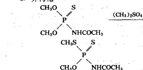
从酰化物高位计量槽将定量的酰化物放入异构化釜中，开启搅拌，随后由硫酸二甲酯高位计量槽按比例将硫酸二甲酯加入异构化釜中，慢慢升温至65—70℃，保持温度2小时。出料，即得乙酰甲胺磷原油。
