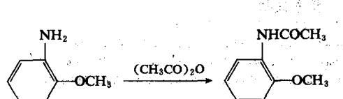
将计量的邻氨基苯甲醚投入反应釜，搅拌下加入冰醋酸。在10—12℃滴加乙酐，2小时左右加完，静置2小时，即得供工业上使用的中间体邻乙酰氨基苯甲醚。配料比为邻氨基苯甲醚：冰醋酸：乙酐=1:0.9:1(重量比)。
