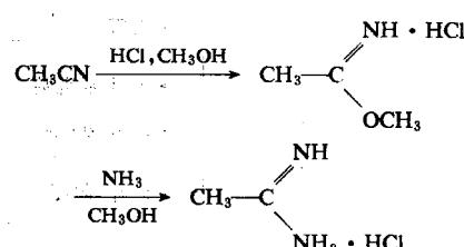
使甲醇在湍球塔内循环，压力小于200毫米汞柱冷却下通入干燥的氯化氢，制成浓度为45%的氯化氢甲醇溶液。然后投入反应罐，搅拌冷却至10—5℃，滴加乙腈，并于15—20℃保温6小时，得亚胺基甲乙脒盐酸盐。放入预先配制好的13%氯甲醇溶液中，在0—40℃氯解，保持pH值7—8，搅拌2—3小时，降温至30℃以下，离心分离滤出氯化铵。滤液回收甲醇，冷却过滤得成品。
