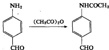
向共沸脱水后的对氨基苯甲醛的苯溶液加入乙酐，继续蒸馏回收苯，并通水蒸气将残存的苯蒸出。然后向反应产物加水，用碳酸钠将pH值调到6.8—7，加活性炭于95—100℃脱色，压滤。滤液冷却结晶，甩滤，于60—65℃干燥，得对乙酰氨基苯甲醛。
