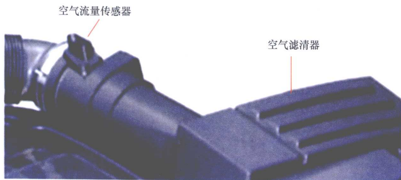
图 2-18 空气流量传感器装配位置 (一)
