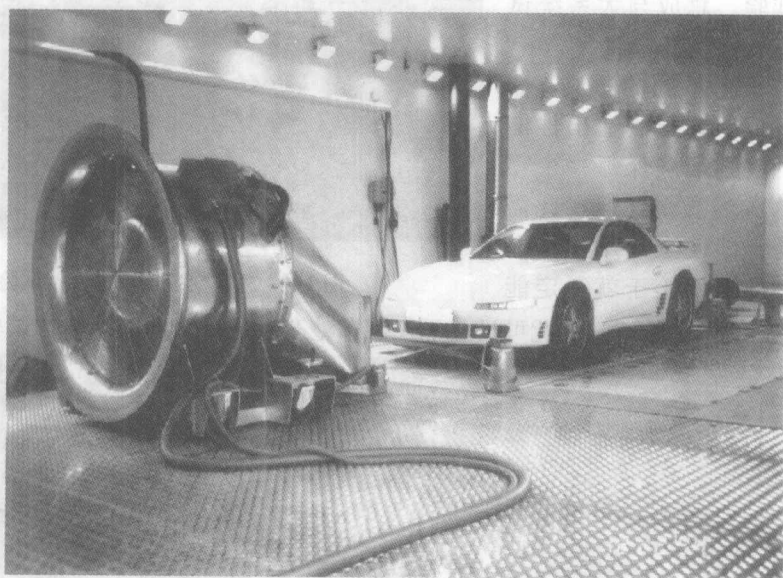
图 1-2 汽车整车室内台架试验
