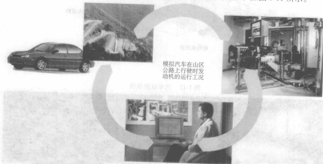
图 1-11 汽车发动机自动试验系统
