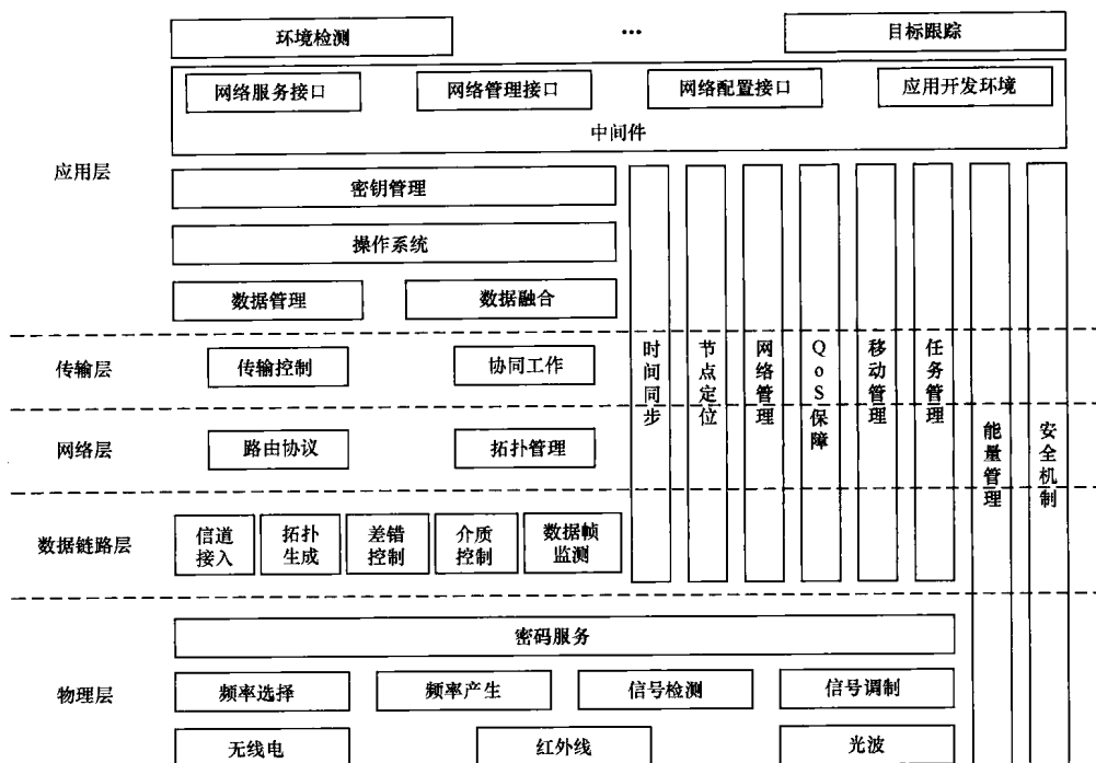
图 1-6 传感器网络协议栈的逻辑层次
