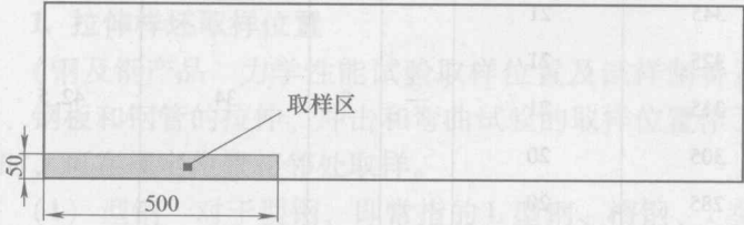
图 1-3 划线以确定取样区
