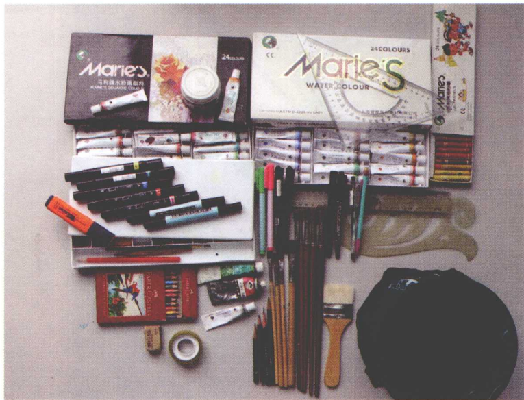
图1.7 建筑表现图的常用工具
