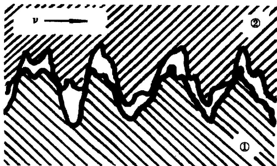
图 1-1 零件表面的机械嵌合
