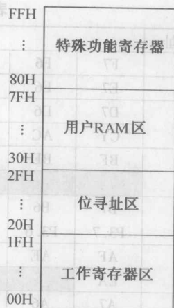
图1.5 片内数据存储器的结构图
