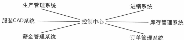
图1-1 服装计算机集成制造系统 (CIMS)
