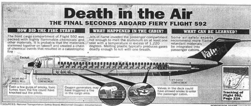
图 1.4 氧气发生器导致飞机坠毁
