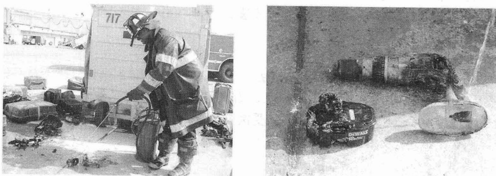
图 1.5 未卸下电池的电钻导致行李着火
