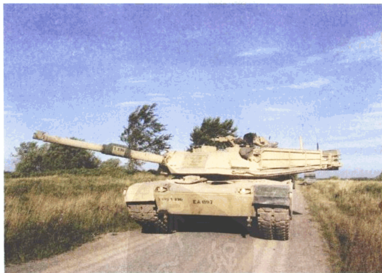
M1A2主战坦克在指挥塔的设计上安装了改进型的同视潜望镜、舱口和机枪座,并取消了高射机枪的电动和手动操纵装置。
