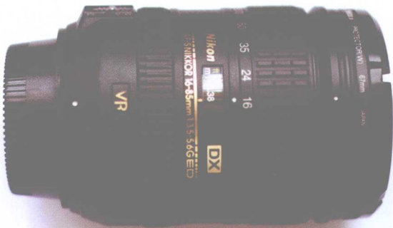
图1-4 广角变焦镜头，焦距16~85mm，1:3.5~5.6D，AF，变焦头，防抖，是尼康单反式数码相机的专用镜头
