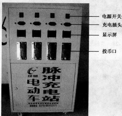
图1-32 “绿盟”牌LM-4投币式电动车脉冲充电站
