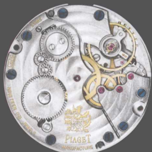
上层表壳机芯： 伯爵制Cal.838P超薄机芯 ■ 上链方式：手动上链 ■ 显示功能：时分指示，小秒盘 ■ 直径：26.8mm ■ 厚度：2.5mm ■ 宝石数：19石 ■ 振频：21,600摆 ■ 储能：约62小时
