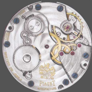
下层表壳机芯： 伯爵制Cal.832P超薄机芯 ■ 上链方式：手动上链 ■ 显示功能：时分指示（24小时制） ■ 直径：26.8mm ■ 厚度：2.5mm ■ 宝石数：19石 ■ 振频：21,600摆 ■ 储能：约62小时
