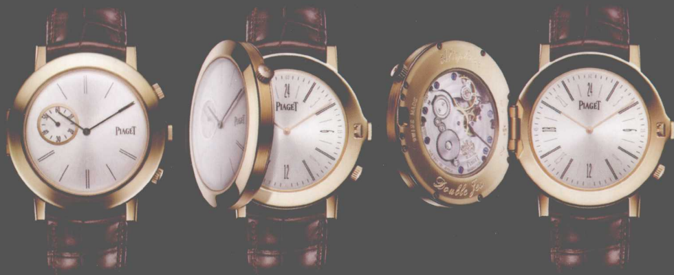
Piaget Altiplano Double Jeu G0A35153 直径43mm 18K玫瑰金表壳 / 上层表壳时分指示，小秒盘；下层表壳24小时制时分指示 / 上层表壳：搭载伯爵制838P超薄手动上链机械机芯，直径26.8mm、厚2.5mm、19石、振频21,600摆、储能62小时；下层表壳：搭载伯爵制832P超薄手动上链机械机芯，直径26.8mm、厚2.5mm、19石、振频21,600摆、储能62小时 / 两表盘均为银色，饰有黑色巴顿时标，巴顿指针 / 上下表壳配蓝宝石水晶玻璃镜面，上层表壳有蓝宝石水晶透明底盖 / 棕色鳄鱼皮表带配18K玫瑰金针扣 / 另有白金款式
