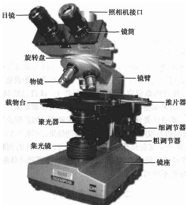
图 1-1 光学显微镜的结构图
