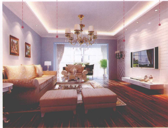
彩色乳胶漆 石膏线条 银镜倒45度角 石膏板拓缝
