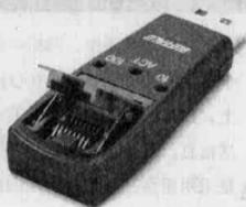
USB(Universal Serial Bus, 通用串行总线)是一种较新的总线标准, 比如用户常见的 MP3、U 盘、摄像头以及部分鼠标、键盘等设备都采用了 USB 接口类型。由于遵循 USB 总线类型的设备支持即插即用, 因此使用非常方便。
