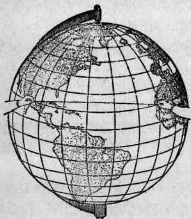
圖 4. 求得兩點之間真正最短路線的簡便方法：在地球儀上的這兩點之間拉緊一條細線
