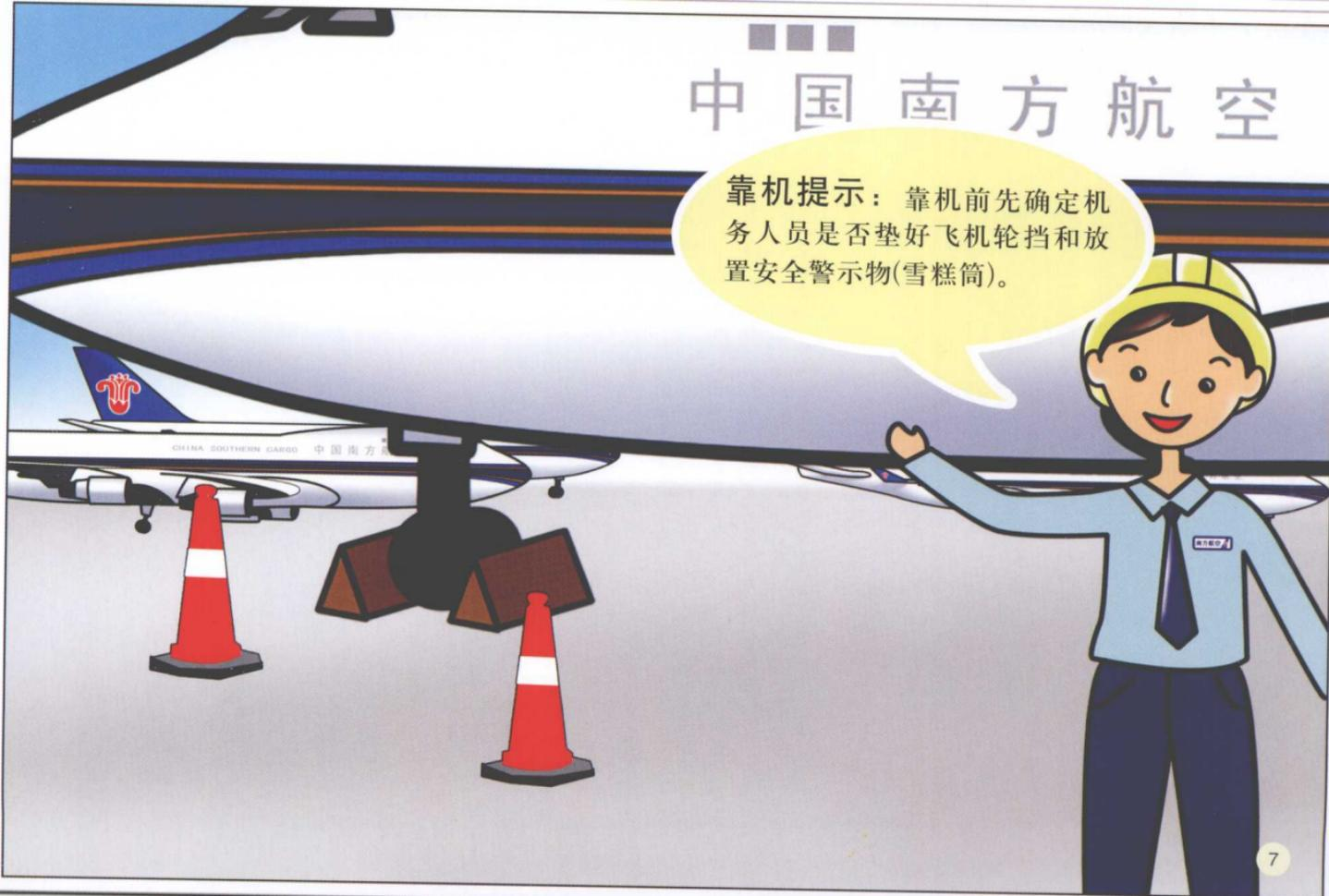
**靠机：**1. 在地面指挥人员的指挥下，以低于3公里/小时的速度靠近飞机，在离飞机货舱门3米左右时停车，置速度控制键于慢行位行进（速度挡不得在快速挡“RABBIT”位置）。
