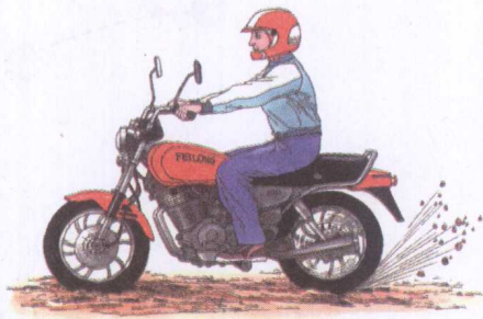
图 1-1-4 泥浆沿车轮边缘的切线方向飞出
