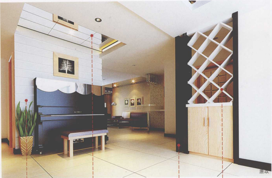
石膏板拓缝 银镜倒角 装饰方柱 板材造型白色聚酯漆饰面
