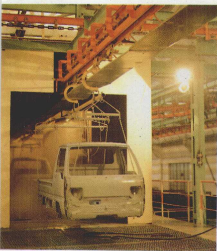
10 全自动电泳涂漆生产线
