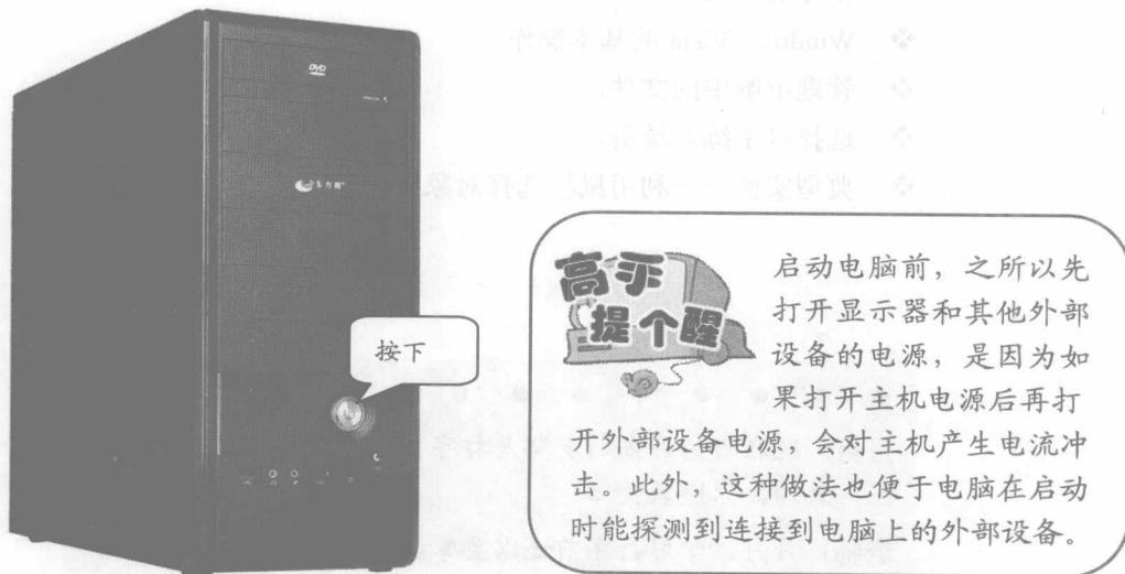
执行上述操作后，电脑开始自动进行自检和启动，并在显示器上显示相应的画面，当电脑启动完成后，会自动进入操作系统的工作界面。
