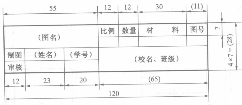
(a) 零件图标题栏
