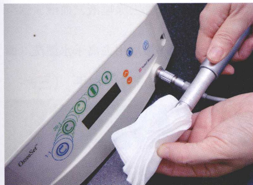
图 2-5 去除多余的手机养护油
