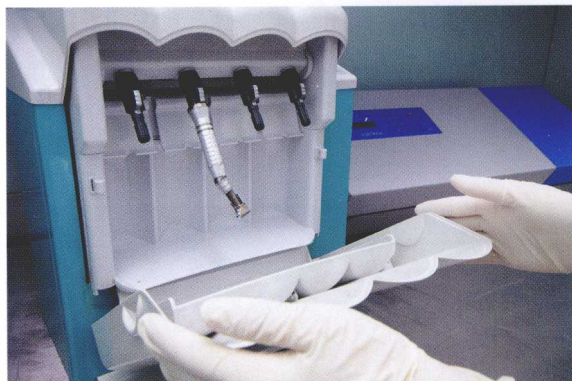
图 2-6 用自动注油机给手机注油
