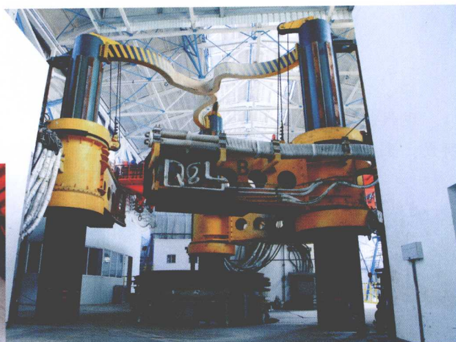
450 吨三相三摇臂双极串联电渣重熔炉投产
