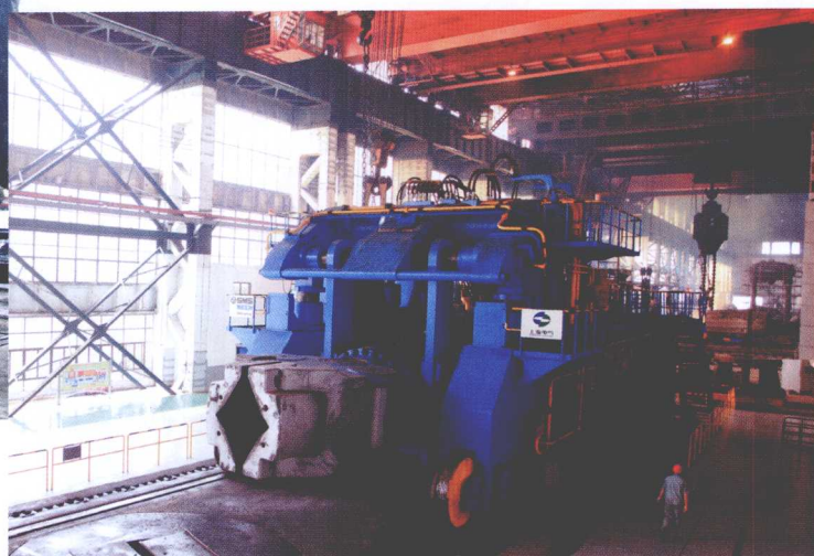
世界领先水平的 250 吨 /630 吨米锻造操作机投入使用
