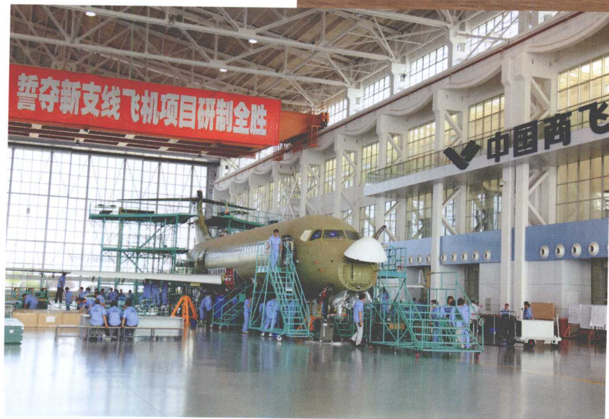
ARJ 21 新支线飞机在上海飞机 厂总装车间总装
