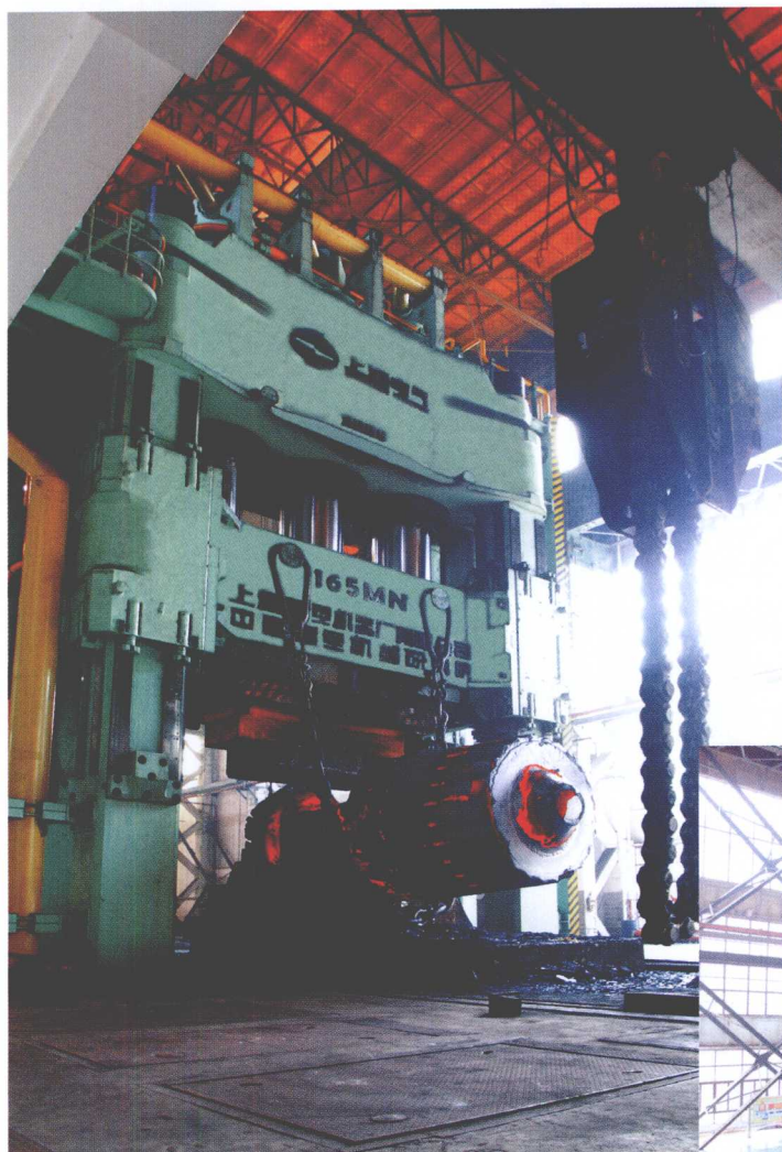
我国第一台 1.65 万吨自由锻造油压机达到国际先进水平
