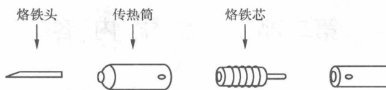
图 1-3 外热式电烙铁结构
