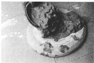
④ 倒在石膏板上吸水。
