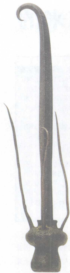
被雷电烧弯了的避雷针
