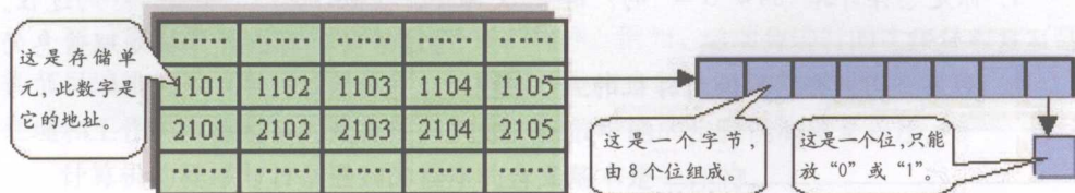
图 1-6 存储器示意图
