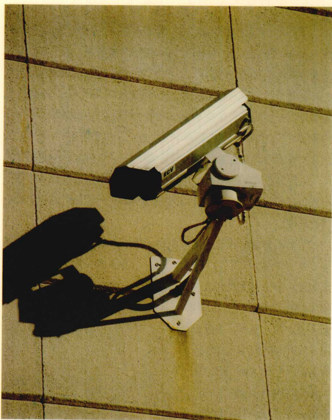
▲如图，在监控范围内，电子感应器如果检测到任何动静，这台监视器就会出现反应。
