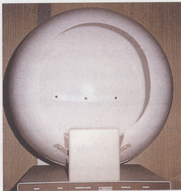
图 1.1 全视野视网膜电图 (ERG) 记录装置的 Ganzfeld (全视野) 穹顶
