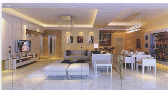
石膏板勾缝 茶镜 墙纸 铁艺栏杆
