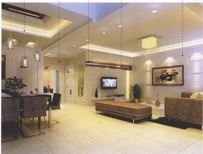
石膏板吊顶 墙纸 茶镜 不锈钢装饰条 石膏板造型
