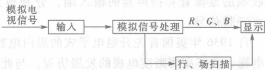
图1-1 模拟电视接收机信号处理流程图
