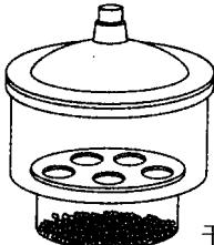
干燥器   | 按颜色分为无色和棕色两种<br>以内径大小表示，如 100 mm、150 mm、200 mm 等 | 内放干燥剂。用于存放易吸湿的物质，也用于存放已经烘干或灼热后的物质和灼烧过的坩埚，以防返潮 | 1. 灼热的物品稍冷后才能放入，防止盖子滑动而打破<br>2. 放入的物品未完全冷却前要每隔一定时间开一开盖子，以调节干燥器内的气压<br>3. 要按时更换干燥剂 |
