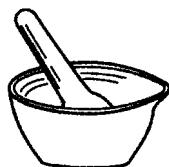
研钵    | 瓷质，也有玻璃、玛瑙或铁制品<br>以口径大小表示，如 60 mm、75 mm、90 mm 等  | 磨细药品或将两种或多种固态物质通过研磨混匀<br>按固体的性质和硬度选用          | 1. 不能作反应容器<br>2. 只能研磨不能捣碎(铁研钵除外)，放入物质的量不宜超过容量的 1/3<br>3. 易爆物质不能在研钵中研磨             |
