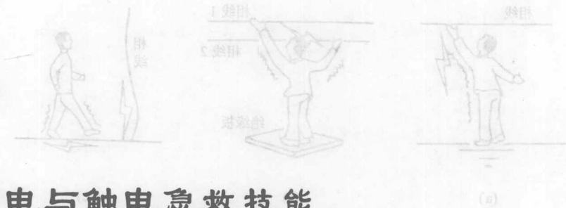
图 1.1 触电类型 (a) 单相触电 (b) 双相触电 (c) 跨步电压
