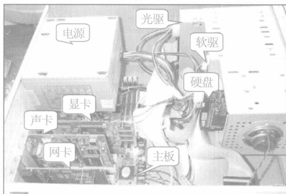
图 1-13 主机的内部结构
