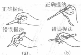
图 1-7 低压验电器握法
