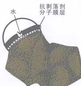
含自身抗水型抗剥落剂的沥青裹复层遇水浸害时 (抗剥落剂膜层完全不溶于水，裹复沥青层完好)
