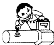
甲: 用超声波检查金属内部是否有气泡、裂痕
