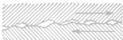
第3—14圖 零件接觸面間的摩擦
