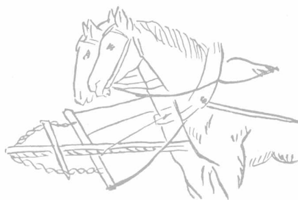
第4—12圖 轅木前端拉杆與小拉杆的裝配
